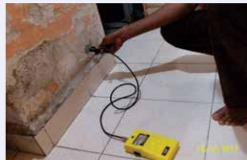
**Fig. 6:** Measuring the moisture content using a moisture meter
